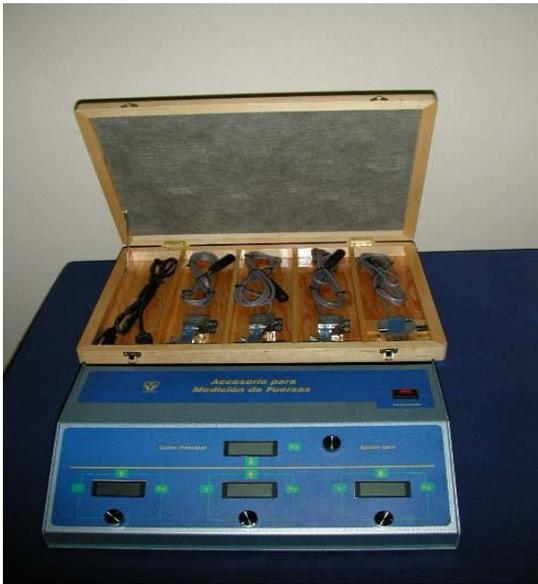
Es un instrumento electrónico para la medición de las cargas aplicadas en el Módulo de Leyva. Se utiliza en sustitución del sistema convencional con que cuenta el aparato que permite calcular las cargas a partir de las presiones detectadas por los manómetros.
